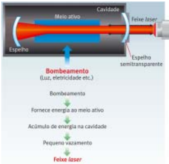
Figura 1. Esquema simplificado das partes que constituem um laser . O bombeamento fornece energia ao meio ativo. Com isso, há acúmulo de energia na cavidade. Nesta, um espelho semitransparente permite um pequeno vazamento da luz produzida, que constitui o feixe de luz laser
